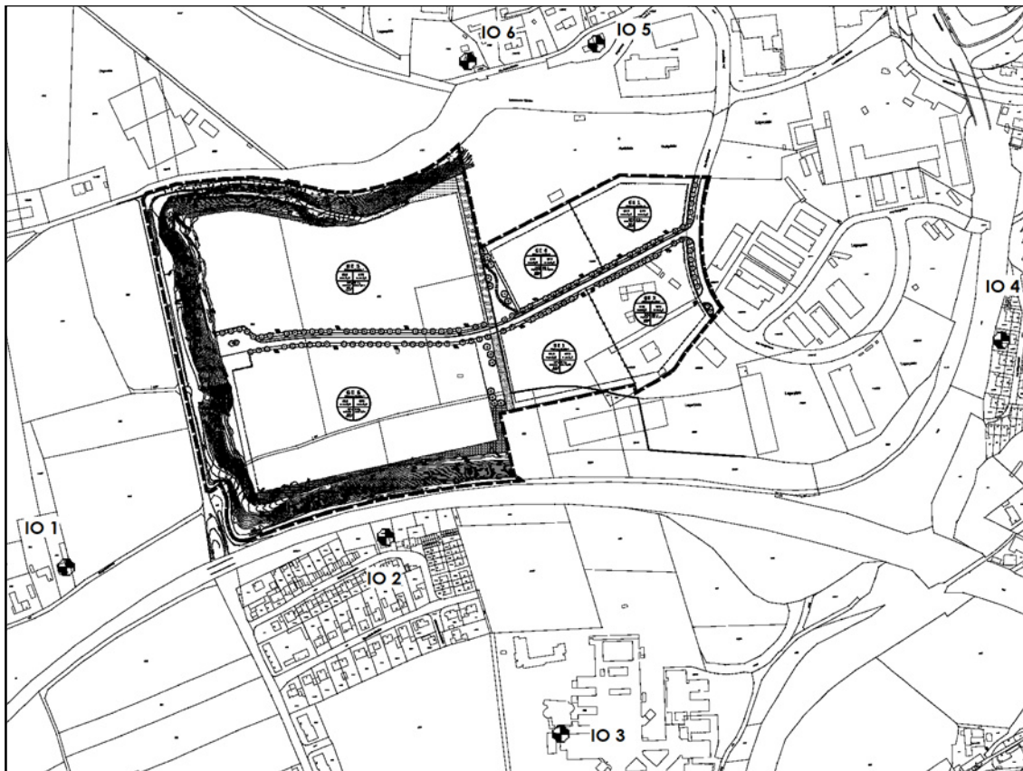
Abbildung 5: Lageplan mit Darstellung der maßgeblichen Immissionsorte für die Geräuschkontingentierung
